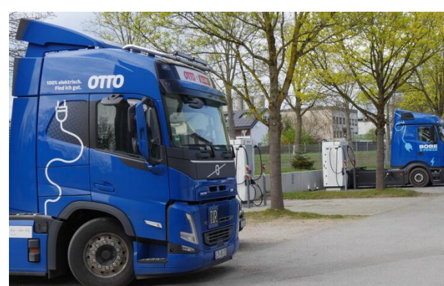
Zwei Ladesäulen mit je 480 kW Leistung und jeweils zwei Ladepunkten hat Spedition Bobe auf dem Betriebshof in Bad Salzuflen. Vorne steht ein etwa zwei Jahre alter Volvo „FME42T“. Hinten ein neuer „eActros 600“ von Mercedes.
